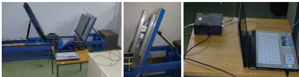
Слика 2 Апаратура за мерење максималне изометријске силе опружача ногу са припадајућом хардверско-софтверском опремом (а), тензиометријска сонда унутар платформе за стопала (б), читач силе са рачунаром (ц)
