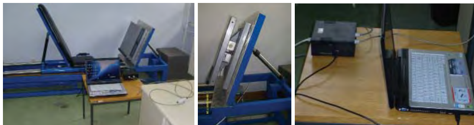
Slika 1. Aparatura za merenje maksimalne izometrijske sile opružača nogu sa pripadajućom hardversko-softverskom opremom(a), tenziometrijska sonda unutar platforme za stopala (b), čitač sile sa PC računarom (c)
